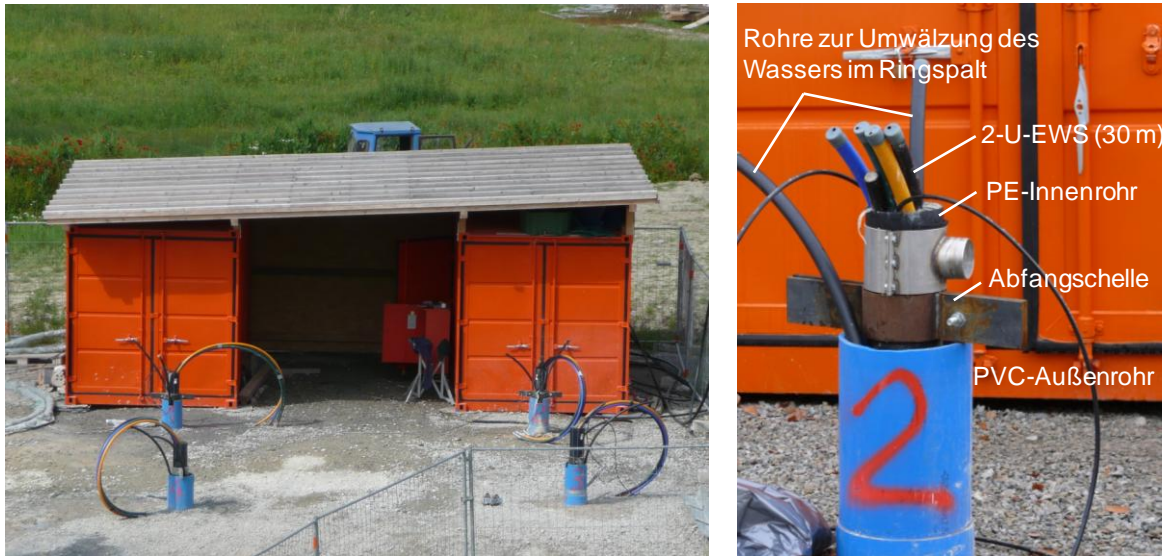
Abbildung 1: Versuchsfeld des Forschungsvorhabens EWSplus (links) und oberes Ende des Versuchsaufbaus (rechts)
