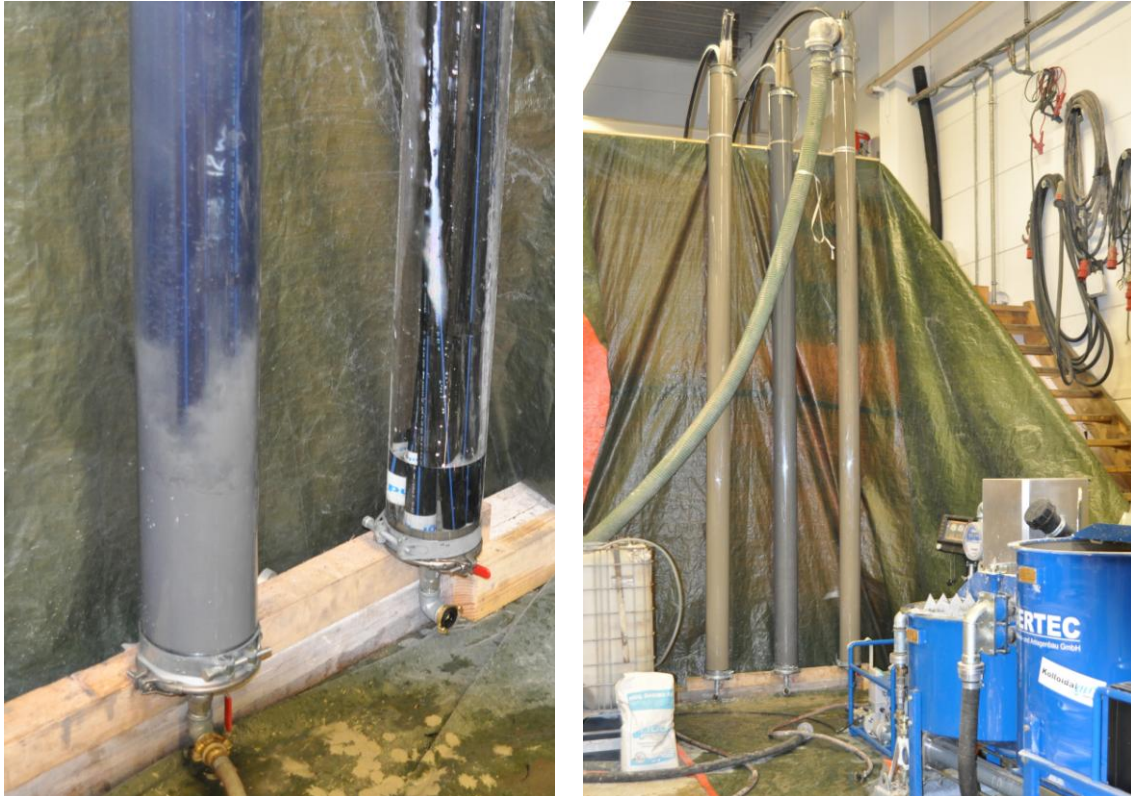
Abbildung 3: Verfüllvorgang des PVC-Rohrs während der Vorversuche (linkes Rohr im linken Bild) und Ansicht der drei in den Vorversuchen verfüllten PMMA-, PVC- und PC-Rohre (von links nach rechts im rechten Bild)
