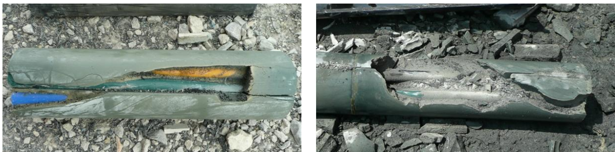
Abbildung 2: Exemplarische Darstellung der in dem Forschungsvorhaben EWSplus beobachteten Verfüllqualität (Riegger, 2013)
