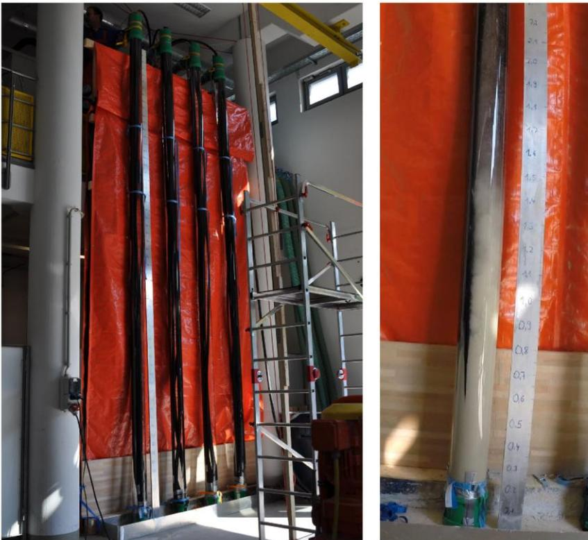
Abbildung 1: Ansicht des Versuchsaufbaus mit den vier transparenten Kunststoffrohren (linkes Bild) und Verfüllvorgang eines Rohres (rechtes Bild)
