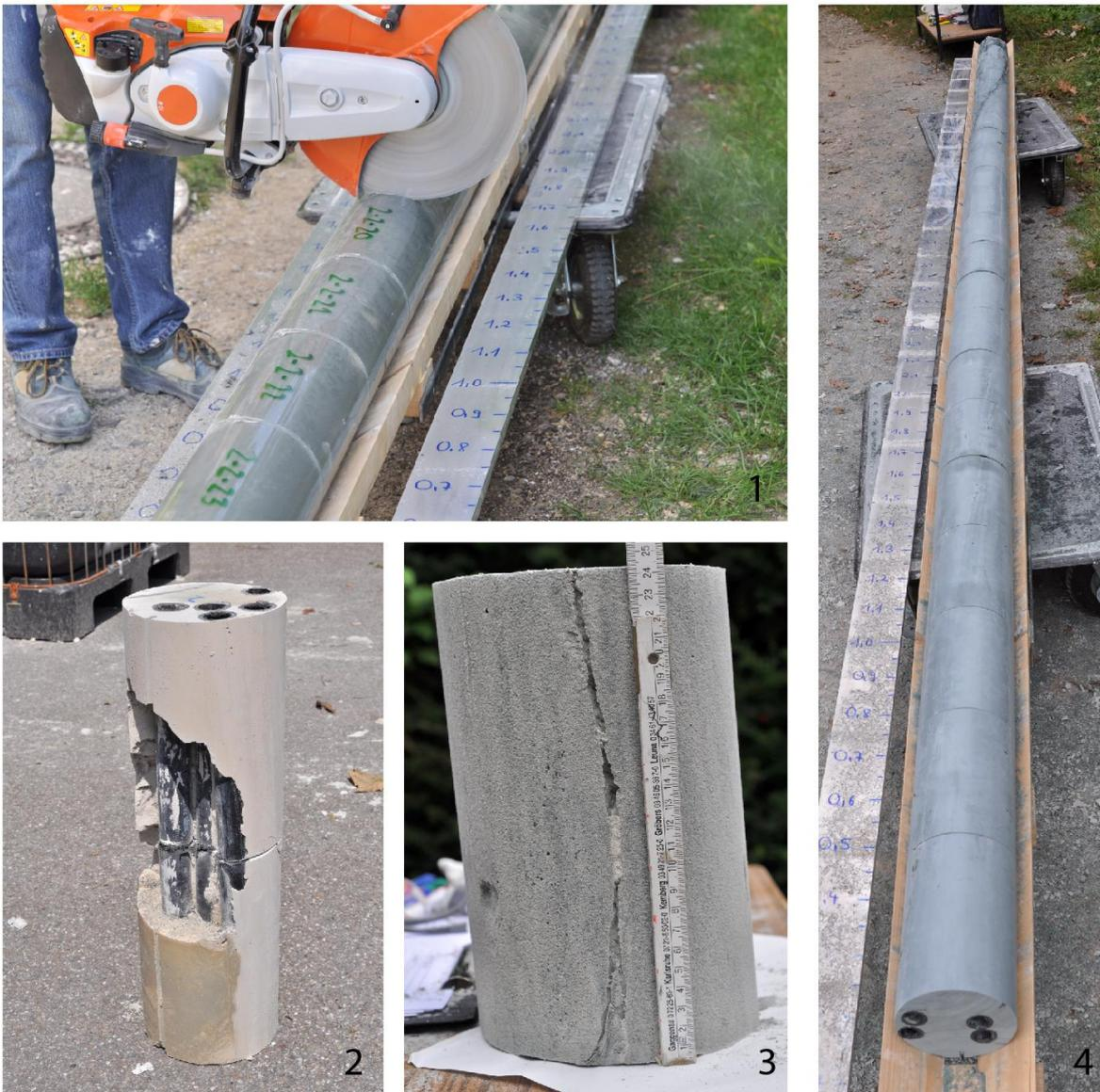
Abbildung 3: Dokumentation der ausgehärteten Verfüllsuspension. Bild 1: Zersägen des Verfüllrohres in 25 cm lange Einzelstücke. Bild 2: Fehlstelle mit einer Ausdehnung von ca. 23 cm. Bild 3: Aufstiegskanal in Längsrichtung der Erdwärmesonde mit sandiger Entmischung im Bildzentrum (Versuchs-Erdwärmesonde mit innen besandetem Hüllrohr). Bild 4: Gesamte Erdwärmesonde zur Dokumentation
