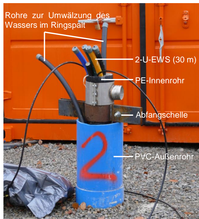
Abbildung 1: Oberes Ende des Versuchsaufbaus
